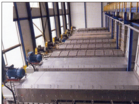
شکل ۷: پرس تفاله‌ها در کارخانه Uelzen
