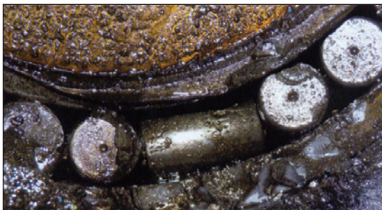
شکل ۱۷: شکستن یاتاقان ساچمه‌ای پرس تفاله
