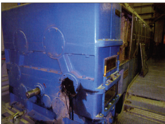
شکل ۱۸: شکستن سرپوش یاتاقان
