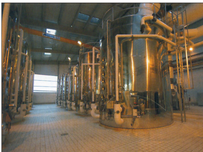
شکل ۱: آبارت‌های پخت ۱ با محفظه حرارتی (Calandria) طرح لانه زنبوری
