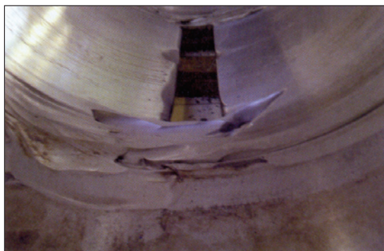
شکل ۱۱: مسیرهای هدایت‌کننده بخار برای خشک‌کن‌های بخار که خورد شده‌اند
