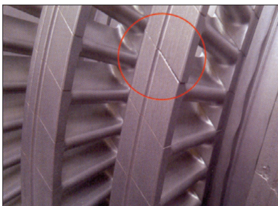
شکل ۱۰: واشرهای لایبرنت که در قسمت سرخم شده‌اند
