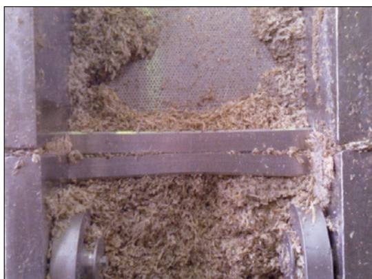
شکل ۸: نگهدارنده‌های توری خم شده در کارخانه Uelzen
