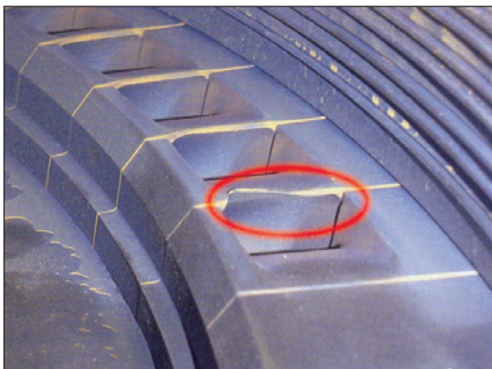
شکل ۱۶: آسیب دیدگی نازل‌های بخار
