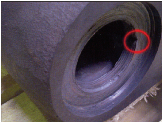
شکل ۱۵: آسیب دیدگی رزوه‌های سرپوش و ننتیل توربین
